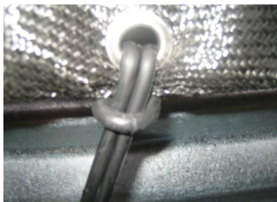
Анкерира се към резервоара посредством каучукови анкери и с използване на галванизирани болтове от комплекта на резервоара
